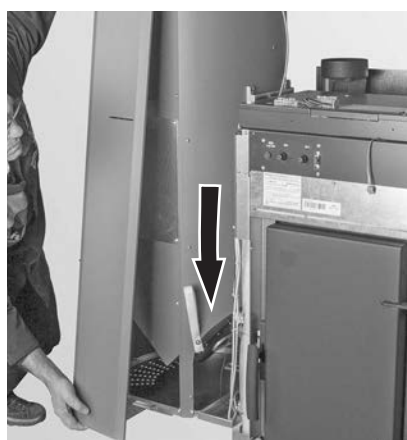
rys. 64 Wciśnij i zdejmij obudowę (zamek bagnetowy)
